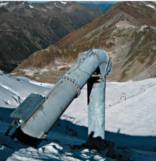
Appareil Gazex destiné au déclenchement des avalanches
